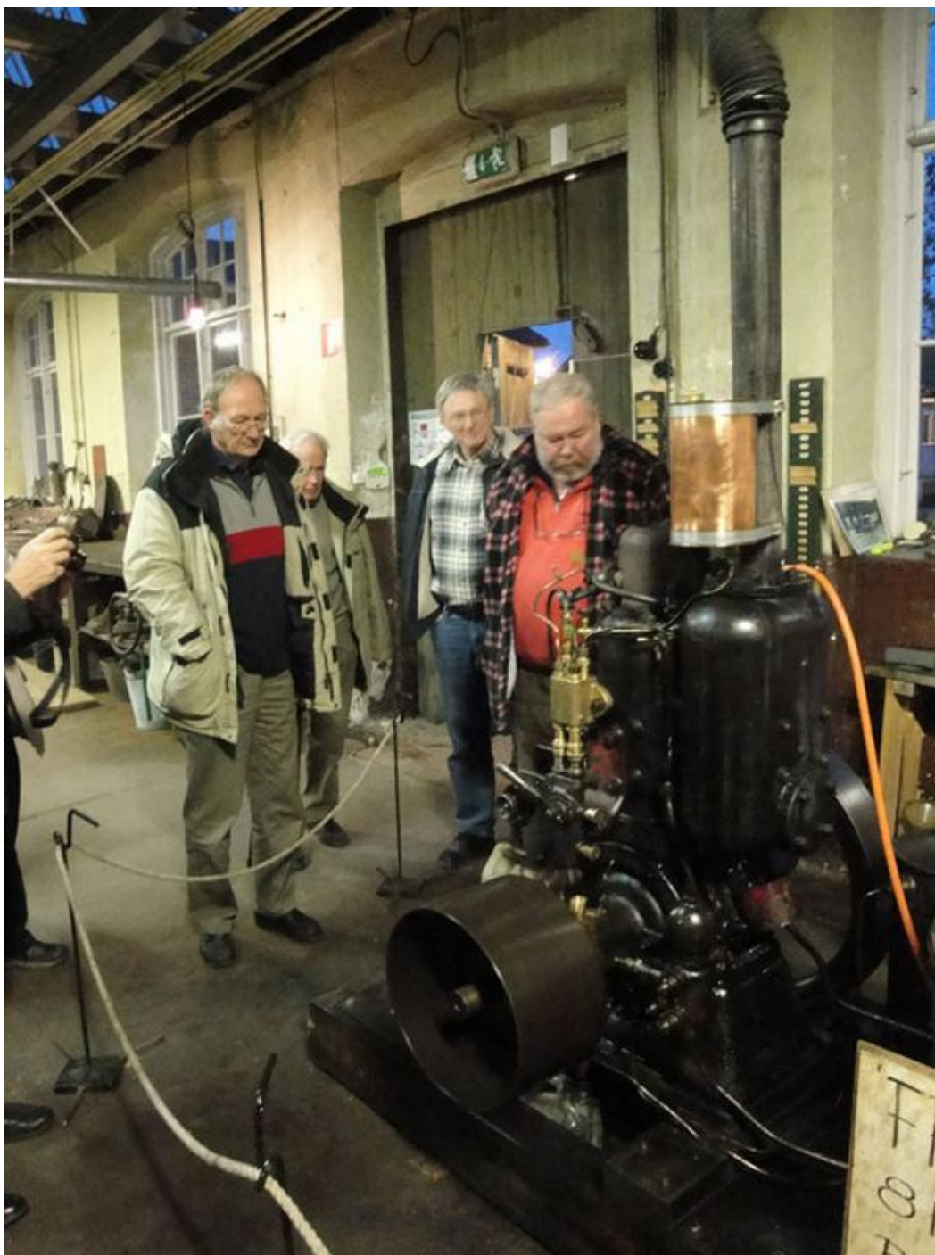
Guiden Lasse Carlsson startar här tändkulemotorn "Fram" från 1914. Data för motorn: 8 hk-450 rpm. Bränsle jordnöts-, torsklever-, majs-, raps-, eller palmolja. Smör går också bra. Man tager vad man haver
